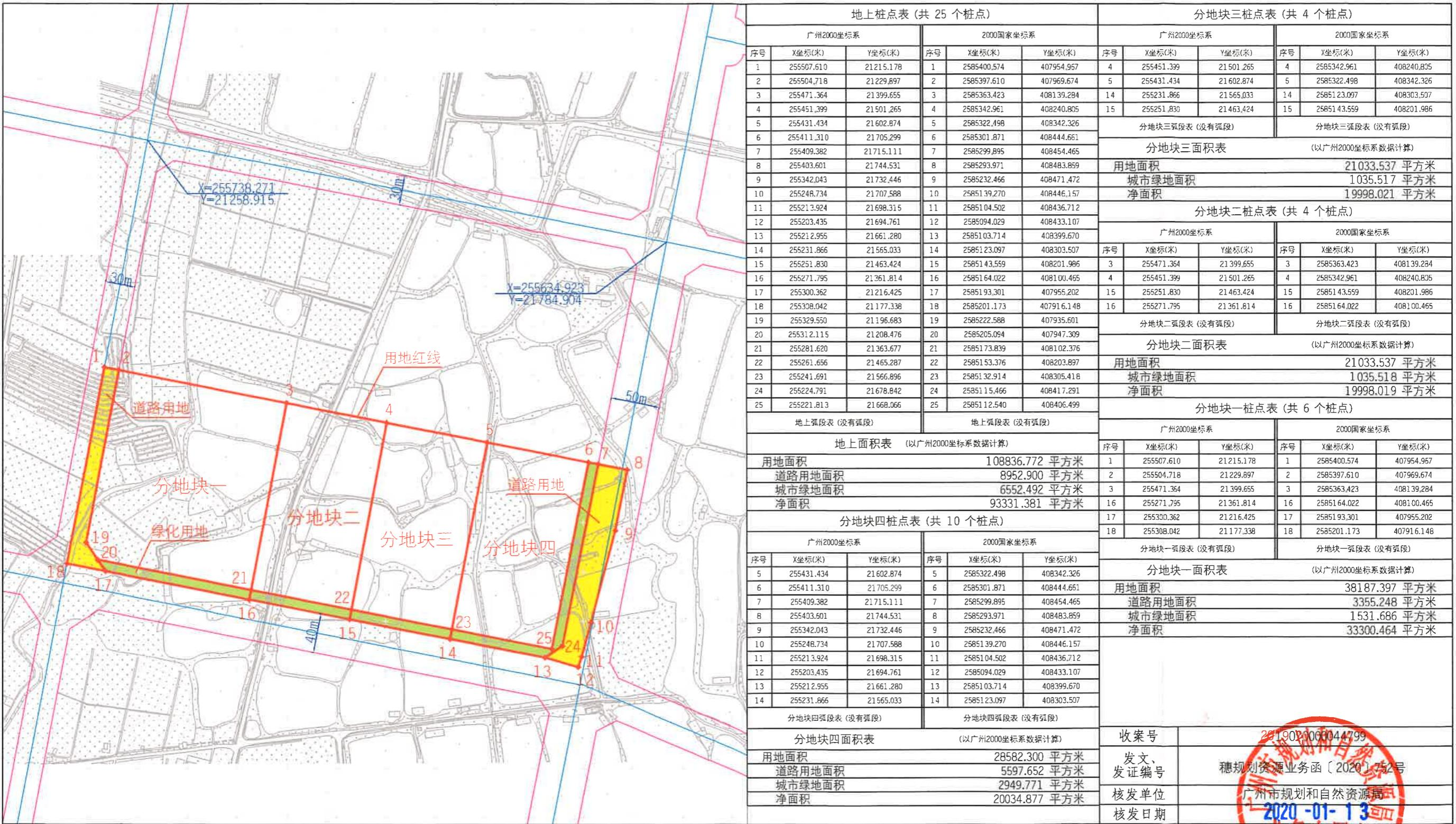
附注: 本图采用广州2000平面坐标系统和高程系统; 图中界桩坐标表之2000国家坐标系数据供国土等部门参考使用。
